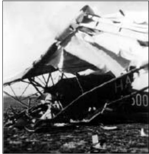
A HA-5006-os jelű Cimborá utolsó felszállása. A csörlés első szakaszában történt kötélszakadás okozta a balesetet, melynek következtében a gép oly mértékben megsérült, hogy javíthatatlanná vált. A BSZKRT-s növendék lábtörésével, Dr. Kunszeri Béla oktató kisebb sérülésével zárult a géptörés (Kosza József Múzeum Kunszeri-hagyatékából)
