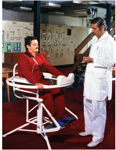
6. ábra: A Nobel-díjas Bárány Róbert, valamint a kecskeméti Repülőorvosi Vizsgáló- és Kutatóintézetben használt Bárány-féle forgószék, amelyet 1977-ben a magyar űrhajósok kiválasztásánál használtak
