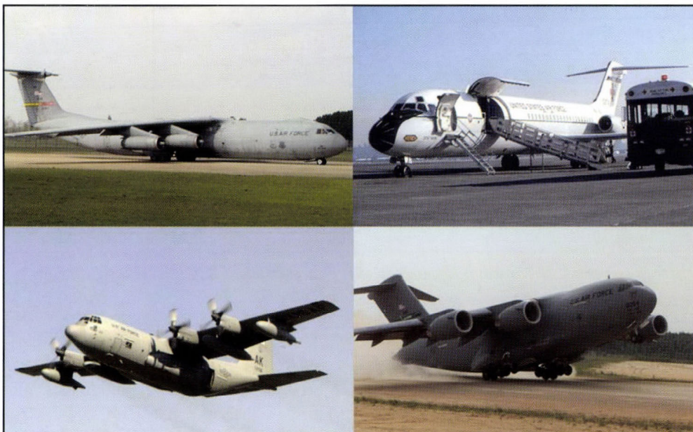
2. ábra: A légi kiürítés során korábban és jelenleg alkalmazott repülőgéptípusok (balra fent: C-141 Starlifter; jobbra fent: C-9 Nightingale; balra lent: C-130 Hercules; jobbra lent: C-17 Globemaster III)
