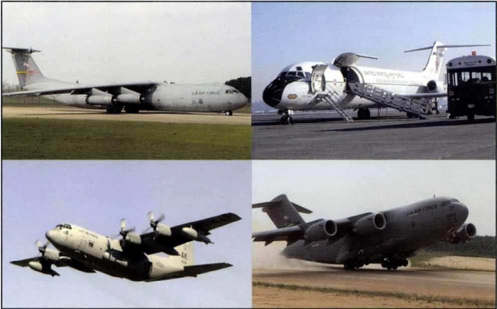
2. ábra: A légi kiürítés során korábban és jelenleg alkalmazott repülőgéptípusok (balra fent: C-141 Starlifter; jobbra fent: C-9 Nightingale; balra lent: C-130 Hercules; jobbra lent: C-17 Globemaster III)
