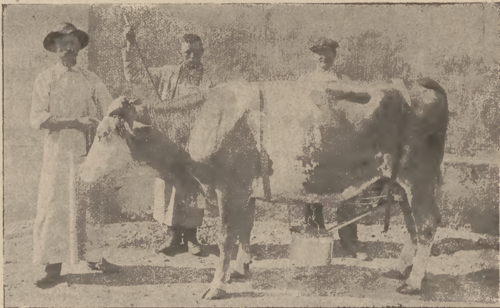
108-ik ábra. Az »Alfa-Dalen« fejtőgép tehénre felszerelve.
