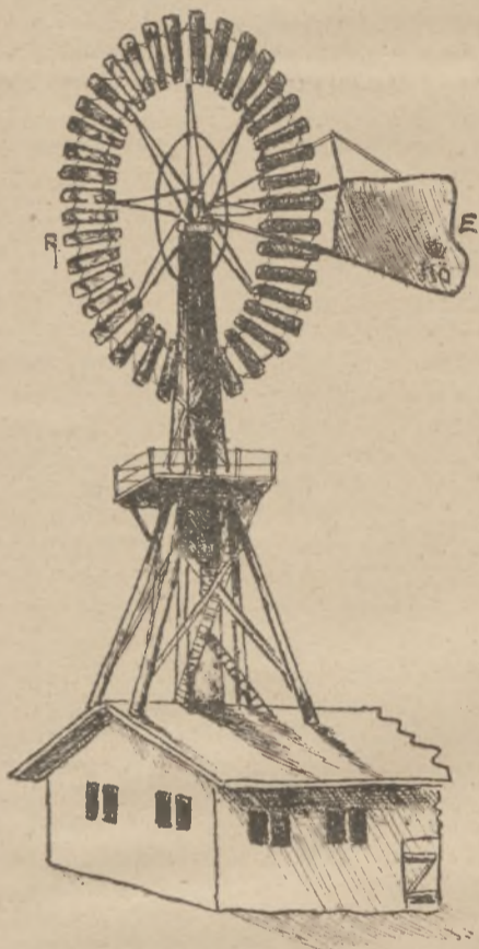
43-ik ábra. Malomra szerelt „Halady“-féle szélmotor.
