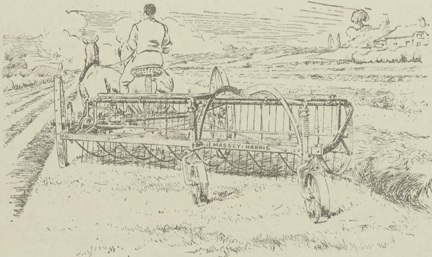
98-ik ábra. Rendszorgyűjtő-gereblyeként működik, a dob előre forog.
