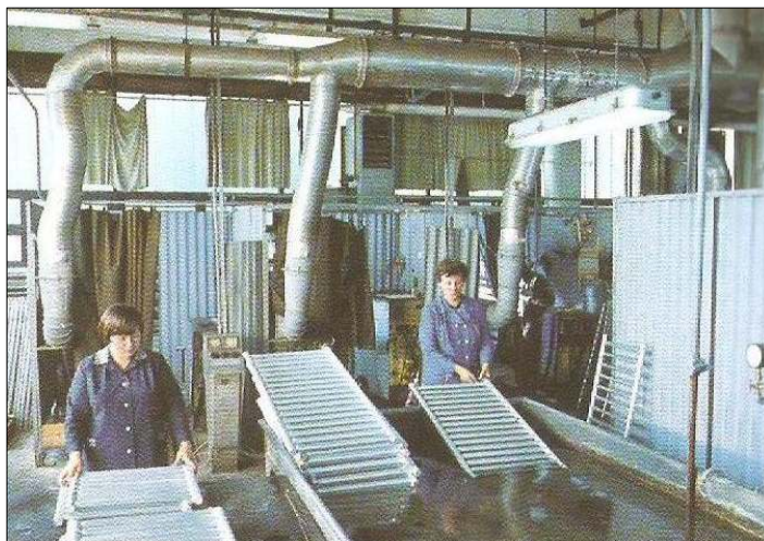
A csőváz nyomáspróbázása
