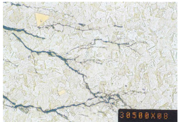
7. ábra. Feszültségi korróziós repedés, maratott Fig. 7: Stress corrosion crack; etched, N = 500x
