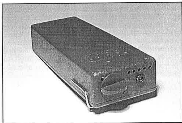
1. kép: A DSZJ-D típusú sugárszintjelző (csipogó)
