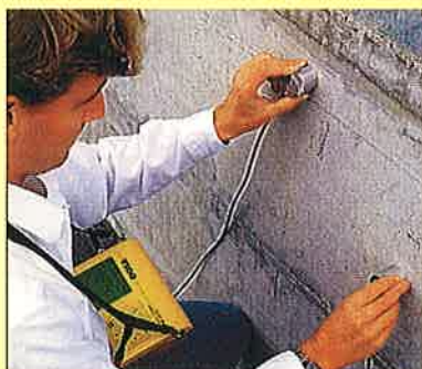
TICO ultrahang készülék Repedések, üregek, fagy- és tűzkárok kimutatásához
