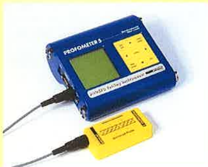
PROFOMETER 5 a betonvas helyének és méretének beméréséhez
