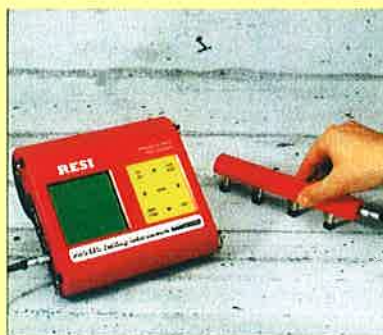
RESI ellenállás mérő a korróziós károsodás felderítéséhez
