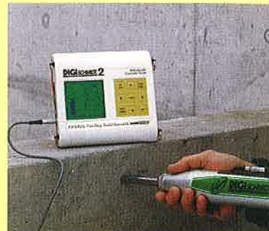
SCHMIDT-KALAPÁCS közvetlen leolvasású készülékek a beton keménységének és szilárdságának méréséhez
