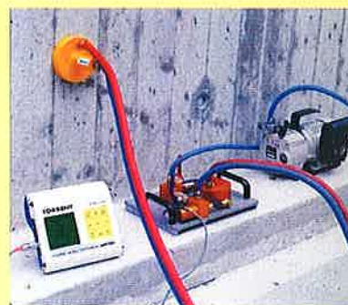
TORRENT permeabilitás mérő a fedő betonréteg minősítéséhez
