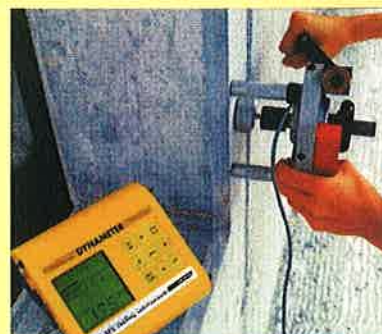
DYNÁ kötésvizsgáló kézi készülék a fedőréteg, a bevonat felületi szilárdságának méréséhez
