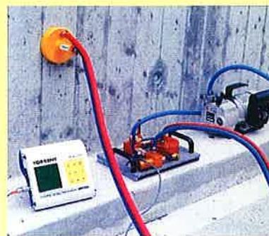
TORRENT permeabilitás mérő a fedő betonréteg minősítéséhez
