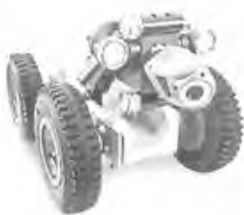
1. ábra. A Rovver 600 típusú önjáró vizsgálórobot
