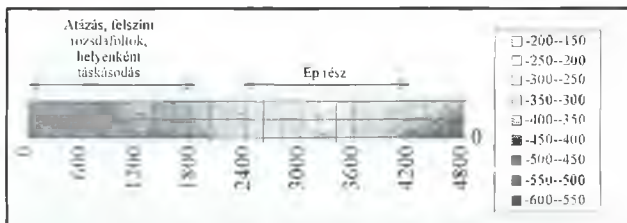
10. ábra. Potenciáltérkép, Csörnöc-patak hídjá (2000. nov. 13.)
