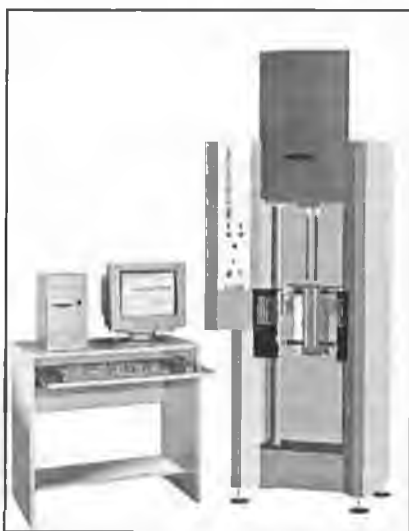
1. ábra. A Ceast Rheologic 5000-twin reométere
