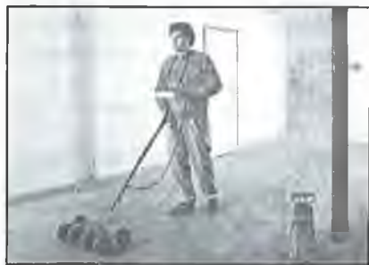
4. ábra. Mérés kerékelektrodával
