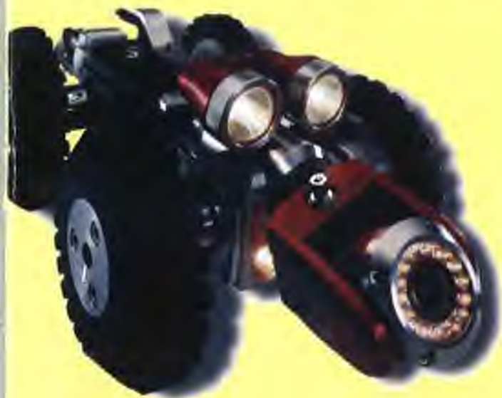
← Rovver® önjáró, távirányítható videokamerás robot család, csővezetékek vizsgálatához
