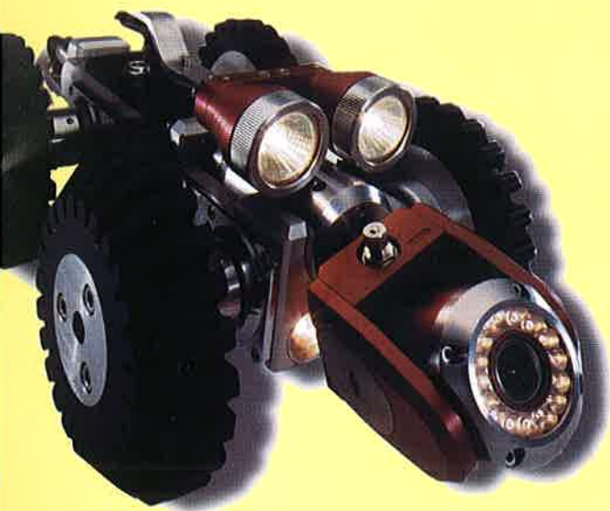
← Rovver® önjáró, távirányítható videokamerás robot család, csővezetékek vizsgálatához
