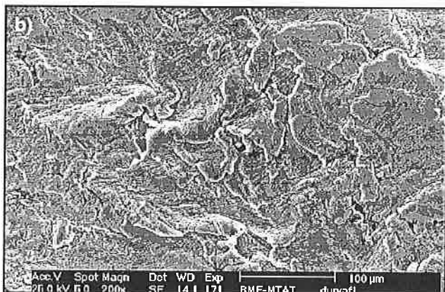
5. ábra. MicroAlu próbatestek oldalfelülete hidrosztatikus nyomás alatti zömítés után (a) és megalakítás után (b)
