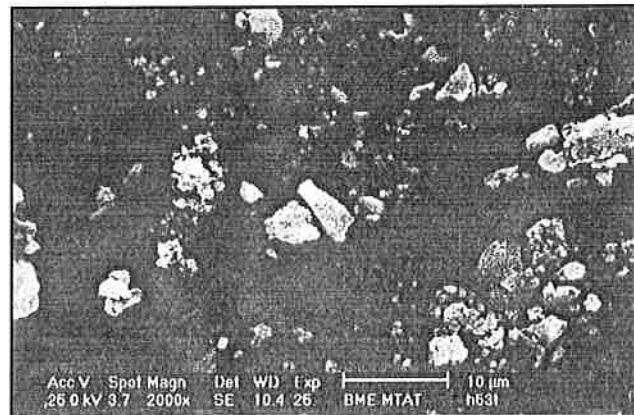
11. ábra. A 10. ábra szerinti forgács a tisztítás után
