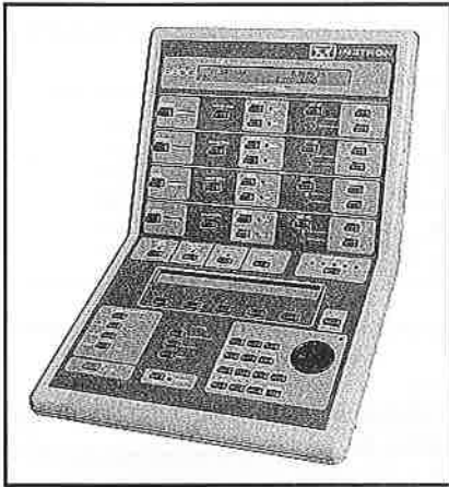
1. ábra. A kezelőpanel, amely gyors és rugalmas lehetőséget ad a közvetlen vizsgálatokhoz számítógép nélkül.
