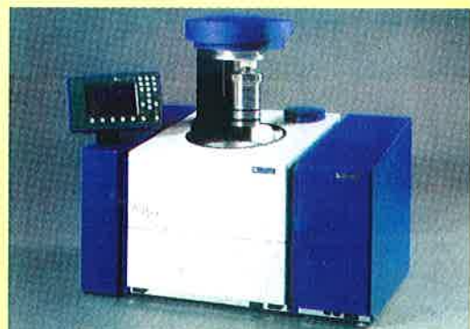
IK A C 5000 típusú kaloriméter
