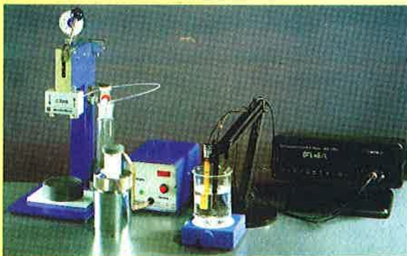
IK A ADD 1 kén- és halogénmeghatározó készülék
