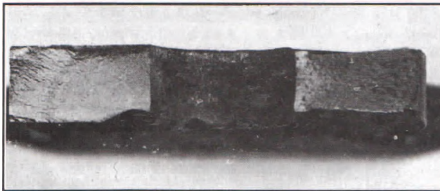
6. ábra A felületi hibákból kiinduló fáradt törés
