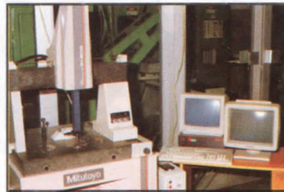
5. ábra Lézeres lemez kivágás adatbevitel mérőgépről
