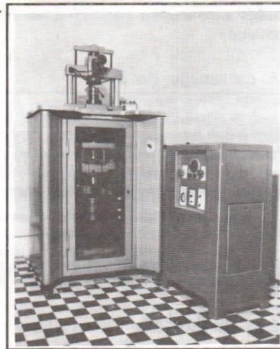
1. ábra Az OMH etalon HRC keménységmérőgépe
