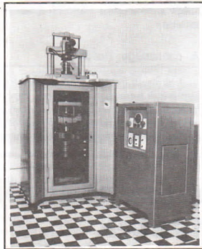
1. ábra Az OMH etalon HRC keménységmérőgépe
