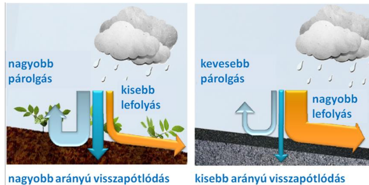
2. ábra. A megnövekedett burkolt felület hatása a lefolyó és beszivárgó csapadékvíz mennyiségére
