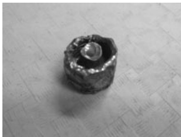
7. ábra: A 25%-os lesüllyedési valószínűségért felelős Al szemcsetípus
