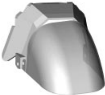
2. ábra: Az új vágóél és vágóéltartó a régi háttal
