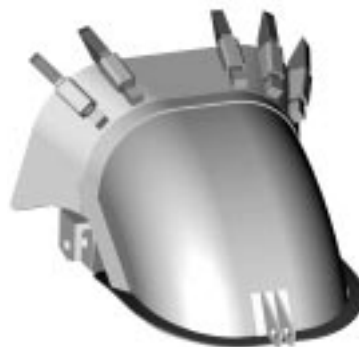
1. ábra: A régi, ívelt elemekből készült meríték 3D-s modellje
