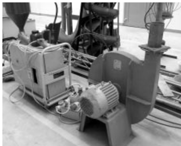
3. ábra: KBV-71 ventilátor a frekvenciaváltóval és a fluidizáló csővel
