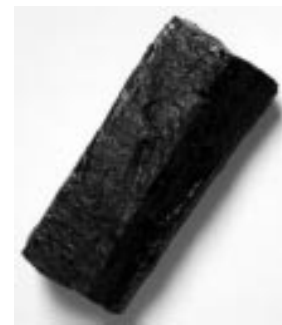
3. ábra: Hatszöges hasáb alakú természetes kocsz, hossz tengelye a telep és telér síkjára merőleges
