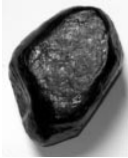
4. ábra: Kissé még szögletes, az elválási síkok mentén keletkezett gömbkőszén
