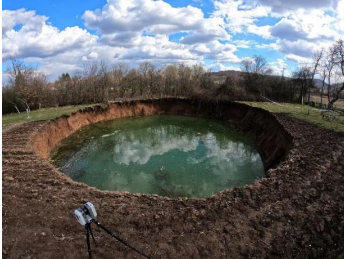
4. ábra. Nagy, 26 m átmérőjű, 12 m mély víznyelő Mečenčani településen (Tomac et al. 2021)
