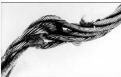
■ 4. ábra. Jellegzetes roncsolódott rész a szakadás közelében
