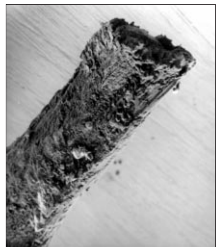
■ 10. ábra. Egy másik drótkötél korróziós kifáradás miatt kontrakció nélkül szakadt elemi szála összehasonlításhoz (N=300x)
