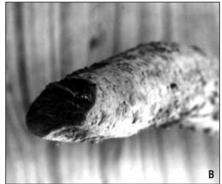
■ 8. ábra. Az elemi szálak deformációja (A kép: N=100x) és kontrakciója (B kép: N=200x) a szakadási helyen
