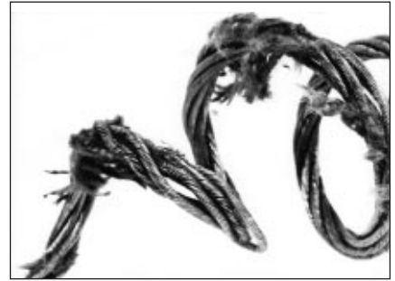
■ 3. ábra. Fokozott roncsolódást okozott a hurokképződés
