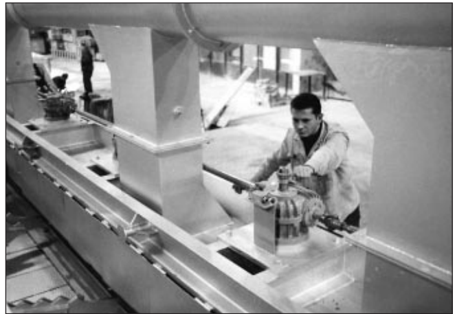
■ 5. kép. Lépegető gerenda és a mértőspirál hajtása
