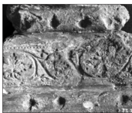
■ 5. ábra. A visegrádi harang öntőformájának töredéke (Fotó: Buzás Gergely)
