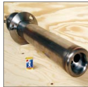
■ 13. ábra. Oxyfuel égő hőálló acélból
