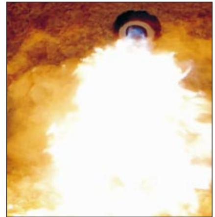
■ 8. ábra. Hagyományos és oxyfuel égő lángképe (szűrőláng)
