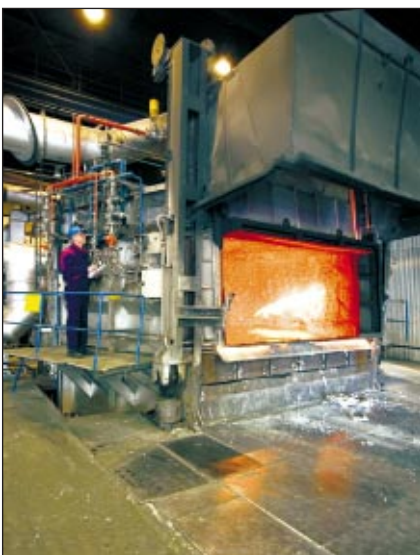
■ 20. ábra. A SAPA 28 t-ás olvasztókemencéje
