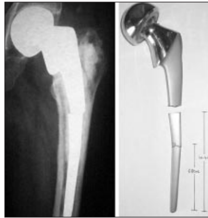
■ 7. ábra. Fáradásos törés 316LVM anyagú csípőprotézis szárán
