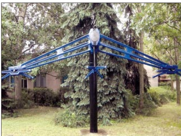
■ 1. kép. Német megrendelésre gyártott pályaudvari tartószerkezet acélöntvényei
