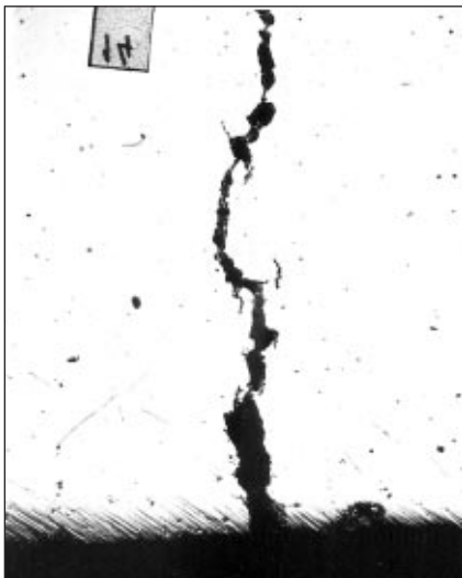
12. ábra. A H jelű öntvény repedése vágási felületnél (N=50x, maratlan)
