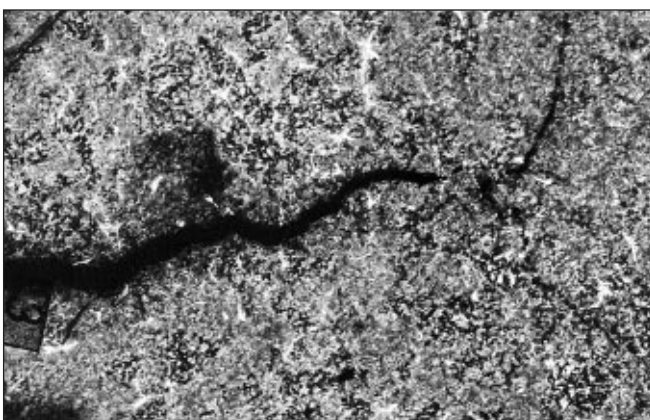
■ 2.a. ábra. Az L jelű öntvény minta finomszemcsés, perlités szövetszerkezete primer karbidhálóval, öntészeti melegrepedésekkel és az összetöréskor keletkezett repedésekkel (N=50x)
