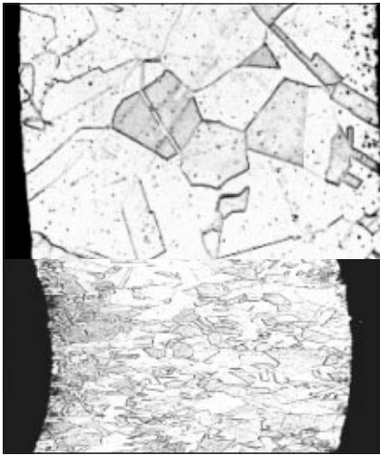
■ 9. ábra. Durva- és finomszemcsés cső; a falvastagság 120 µm
