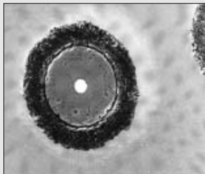
Gyémántbevonatos SiC-szállal (Textron) erősített Ti-mátrixú kompozit keresztmetszeti képe
