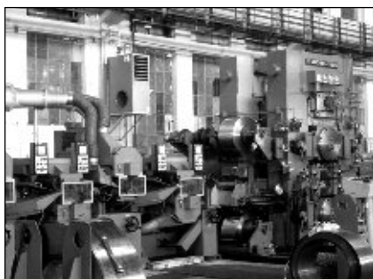
■ 12. ábra. A hidegplattírozó hengerállvány
