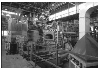
■ 5. ábra. Az új rézfinomító: redukáló – anódöntő kemence
