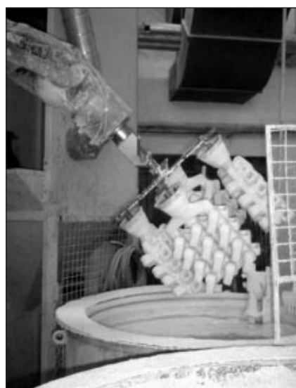
■ 2. kép. Az ipari robot bemártja és megforgatja a szuszpenzióban a viaszmintát
