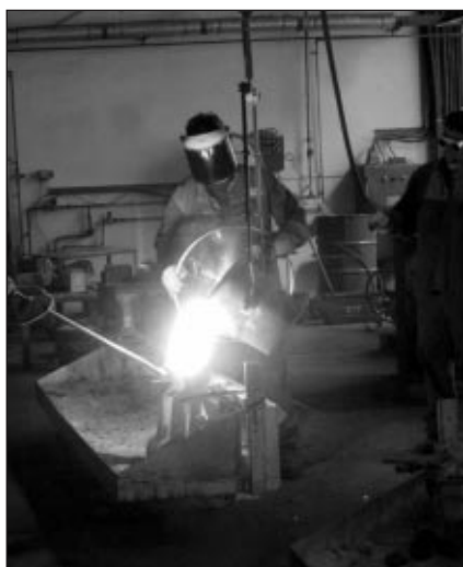
■ 4. kép. Kézi üstből öntik az acélt a kiizzított héjformába
