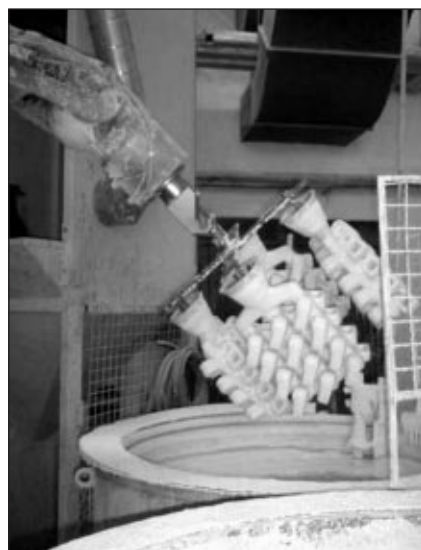
■ 2. kép. Az ipari robot bemártja és megforrasztja a szuszpenzióban a viaszmintát
