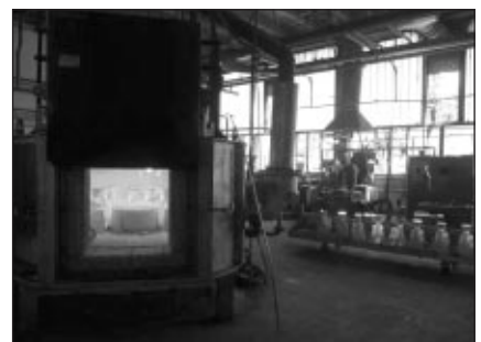
■ 3. kép. Részlet az öntőcsarnokból, balra a nyitott ajtajú héjizzító kemence
