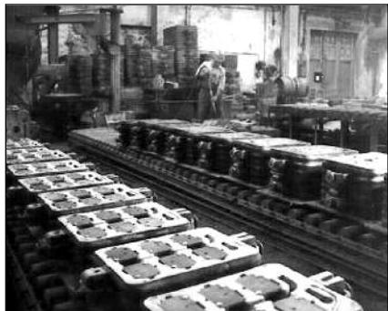
■ 5. ábra. A Danuvia részére gyártott útszelepek formái öntés előtt, 1970-es évek
