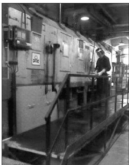
■ 7. ábra. A Degussa cég által gyártott sófürdős tisztítóberendezés belső furatok tisztítására, 1970-es évek
