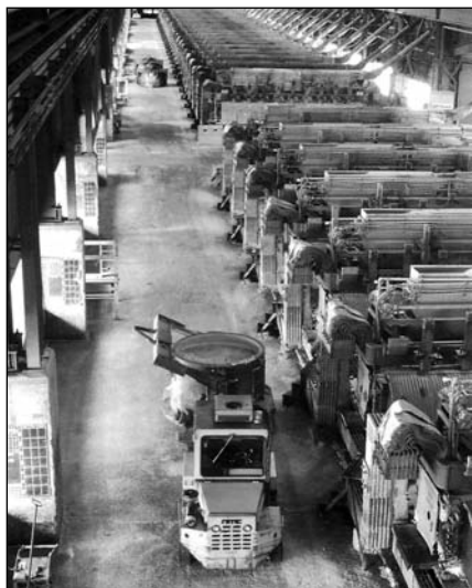
■ 4. ábra. P-69 típusú kád kétoldali árambevezetéssel, végfelszállós változat
