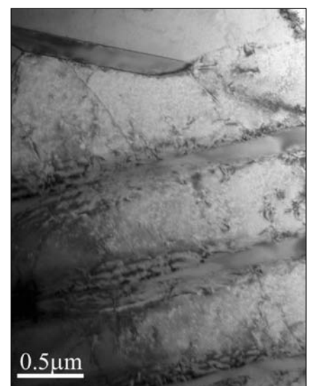
■ 9. ábra. A kéreg felszínén kialakult nanokompozitban, a ferrit/cementit határán induló és sűrűsödő diszlokációkkal
