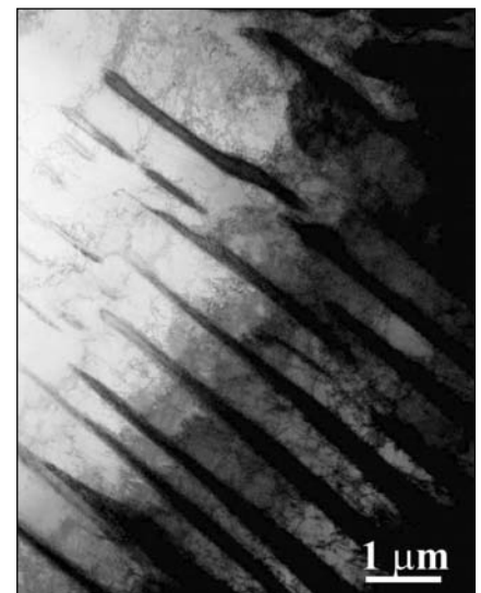
■ 8. ábra. A kéreg felszínén kialakult nanokompozit ferritszemcséi az őket elválasztó cementitlemezekkel
