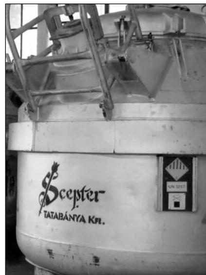
■ 2. kép. Olvadt alumínium szállításra alkalmas üst
