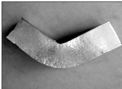
■ 8. ábra. Egy referenciadarab és egy dupla kompozit darab tönkremenetelének különbsége
