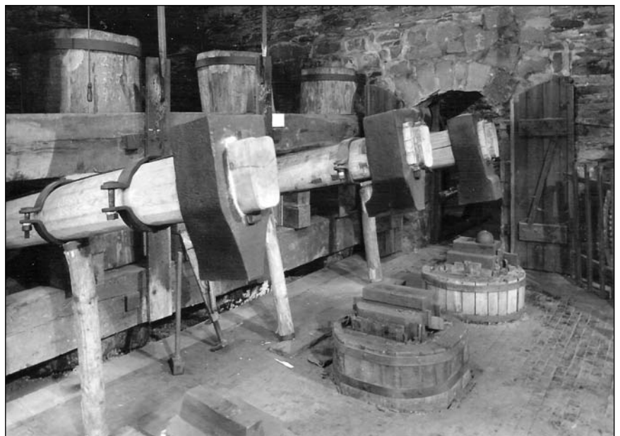
■ A hámor három különböző méretű farkaskalapácsa (rekonstrukció)
