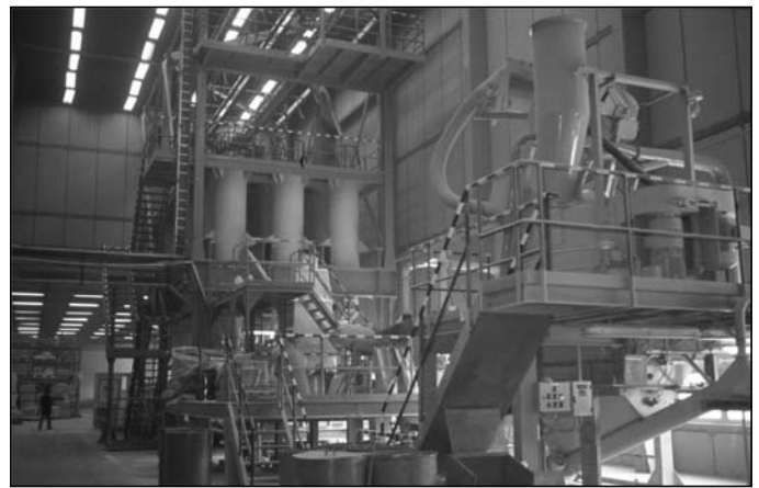
■ 10. ábra. Az ívhegesztő elektródagyártás automatikus porkimérője
