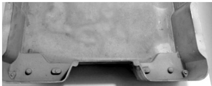
Alumínium gravitációs homoköntvény Ötvözet: AlSi10Mg Méretek: 600 × 450 × 130 mm, falvastagság: 3,5 mm
