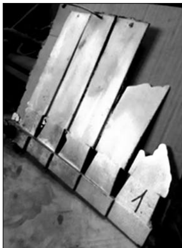
■ 3. ábra. Kifolyási hibák AISi10Mg ötvözetnél. Öntési hőmérséklet 760 °C, 1 db álló, magassága 180 mm
