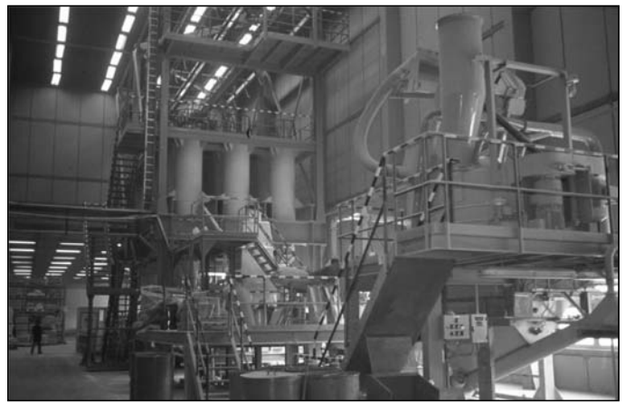
■ 10. ábra. Az ívhegesztő elektródagyártás automatikus porkimérője
