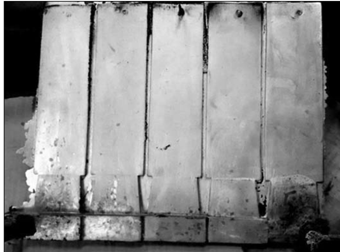
■ 4. ábra. AISi10Mg ötvözetből 720 °C hőmérsékletű olvadékból, 2 db, 180 mm magas álló alkalmazásával öntött próbatestek
