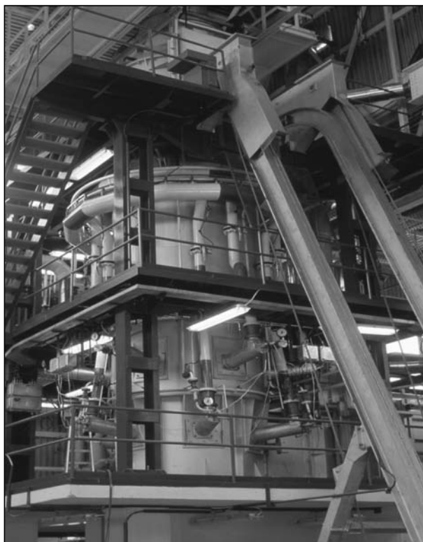
■ 11. ábra. A rézfinomító Asarco-típusú aknás kemencéje
