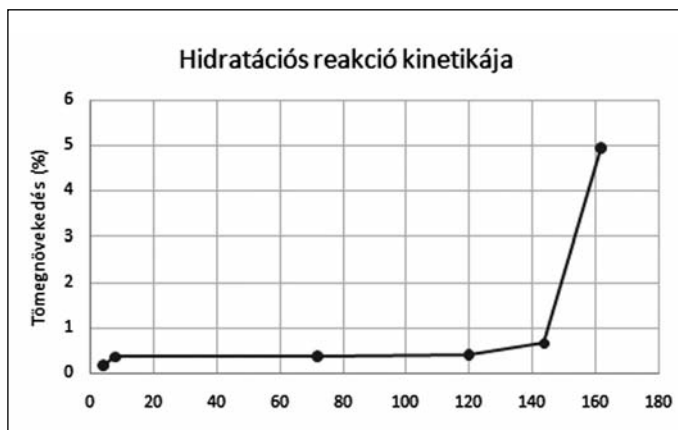
■ 3. ábra. A salak hidratációs kinetikája a hidratációs idő függvényében
