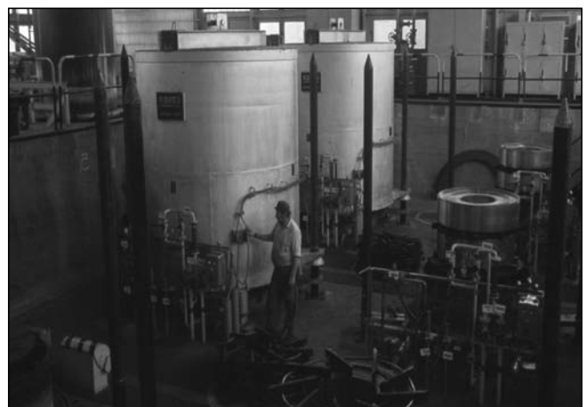
■ 8. ábra. Védőgázos fényeslágyító berendezés
