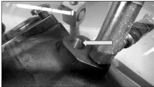
■ 11. ábra. Fékolló ház szivárgási vizsgálata
