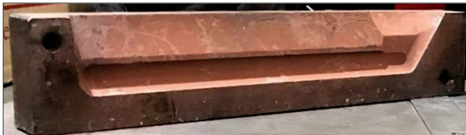
■ 1. ábra. Diez-kokilla nyitott állapotban
