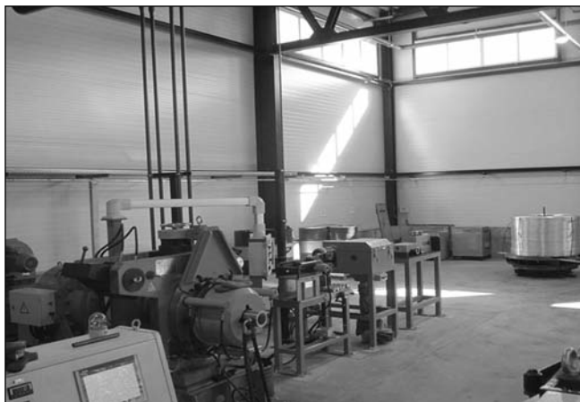
■ 6. ábra. A leadó berendezés, az egyengető, a kefélő és a sajtó
