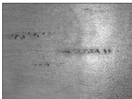
■ 7. ábra. A behengerelt revéhiba leggyakoribb formája
