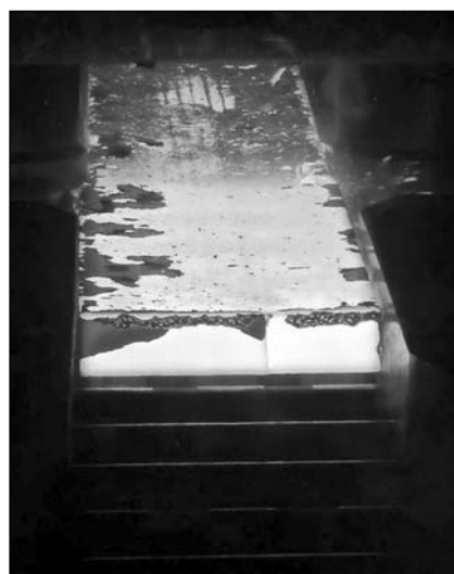
■ 2. ábra. Az előnyújtói függőleges állvány megtöri a revét a felületen
