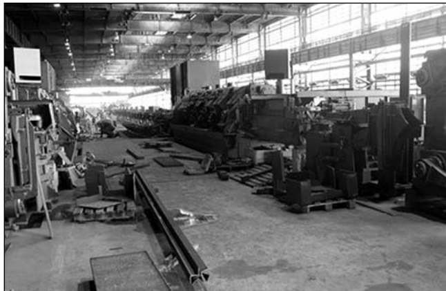
■ 8. ábra. A telepített drótsori hengerállványok, háttérben a víz-hűtő szakasz
