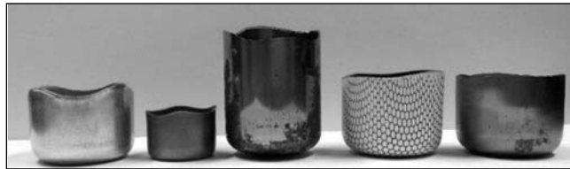
■ 2. ábra. Fülesedés megjelenése mélyhúzásnál (saját felvétel)
