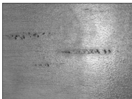
■ 7. ábra. A behengerelt revehiba leggyakoribb formája
