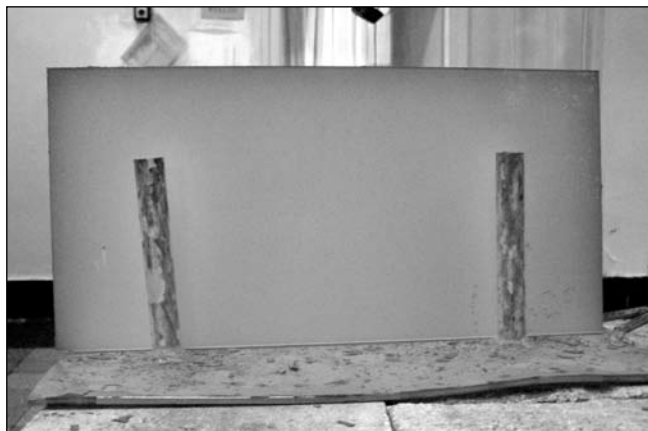
■ 6. ábra. Foltosodásra nem hajlamos magnetites revéjű mintalemez hevítés előtti és utáni állapotban
